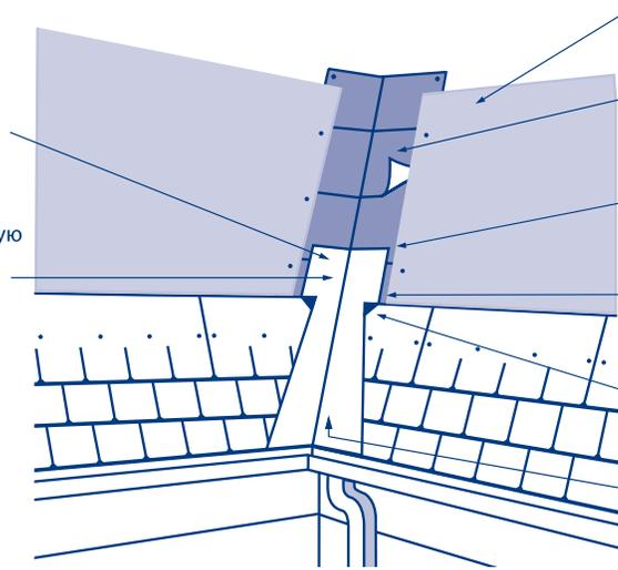
Уложите в желоб подкладочный материал Deck-Armor™ или иной корпорации GAF на гидроизоляционную мембрану с минимальным нахлестом 150 мм.
